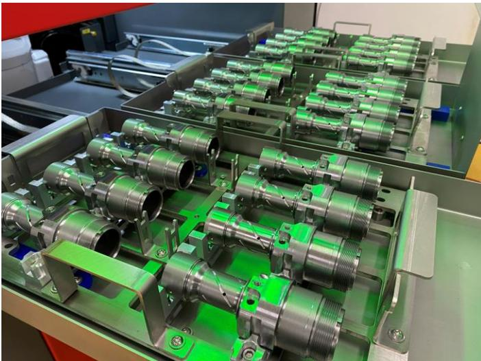
**Bildtext:** Warenträger mit Hydraulikblöcken, die Intercable Tools in Zukunft mit der Ultraschallentgrat-Technologie von ultraTEC innovation automatisiert entgraten kann.
