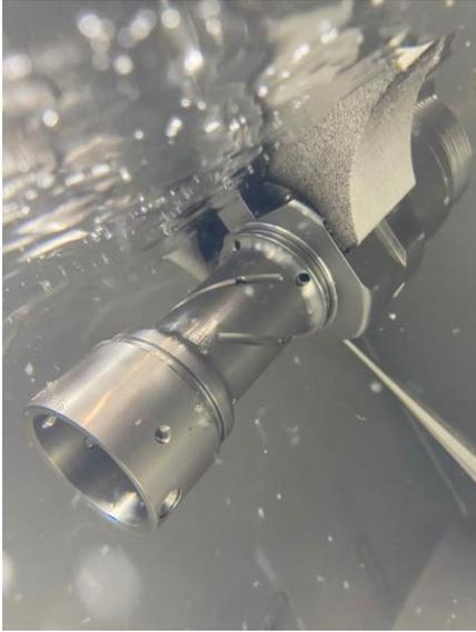
**Bildtext:** Der Prozess des Ultraschallentgratens der Hydraulikblöcke findet mit der ultraTEC Technologie über eine Ultraschall-Sonotrode statt, deren erzeugte Schwingungen Grate und Fasern energieeffizient ablösen.
